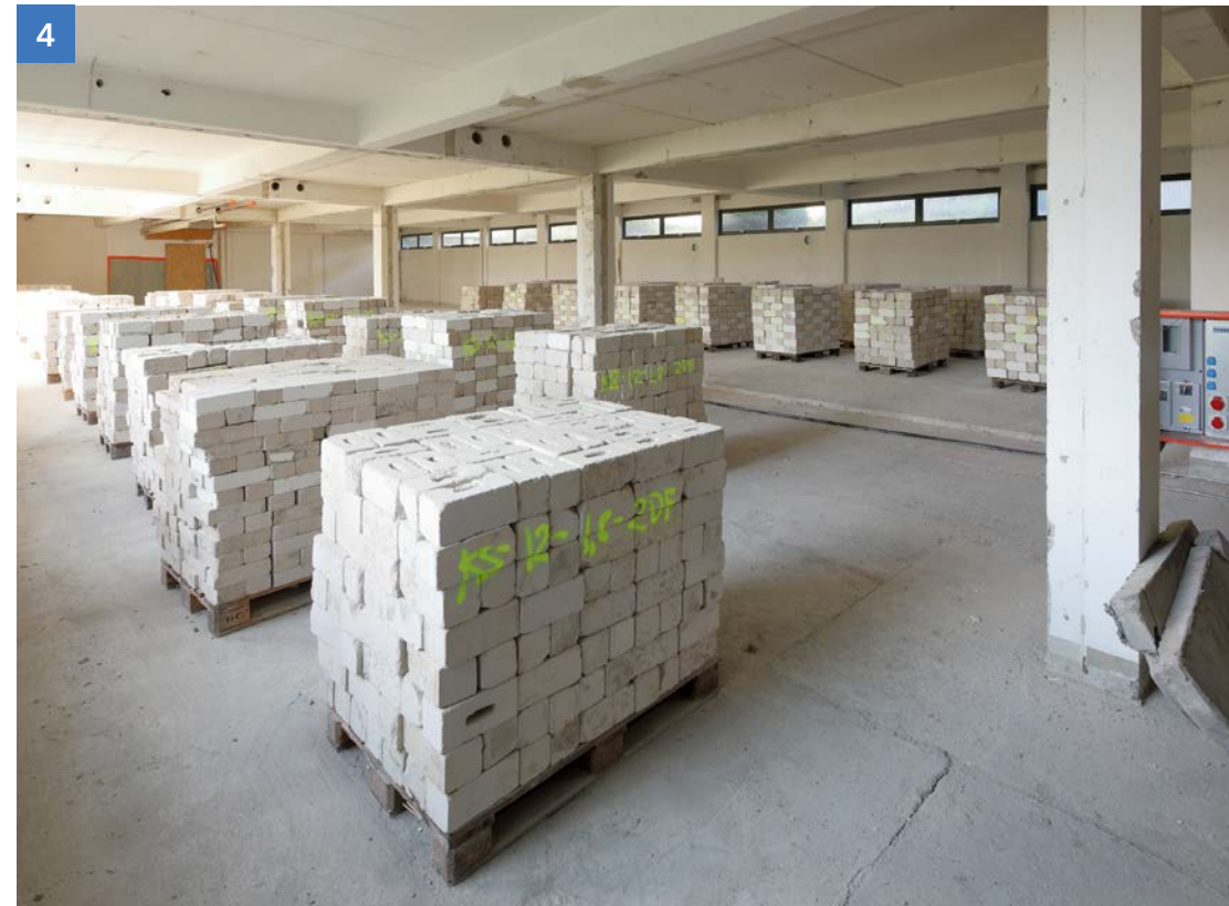
Abbildung 4: Die Kalksandsteine der CAU-Fakultätenblöcke sollen wiederverwendet werden.
